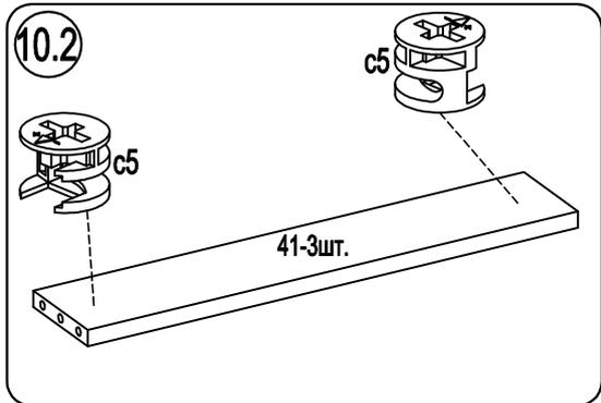
Ориентация стяжки C5 – показана на рис, после сборки с дюбелем в4 стяжку затянуть по стрелке
